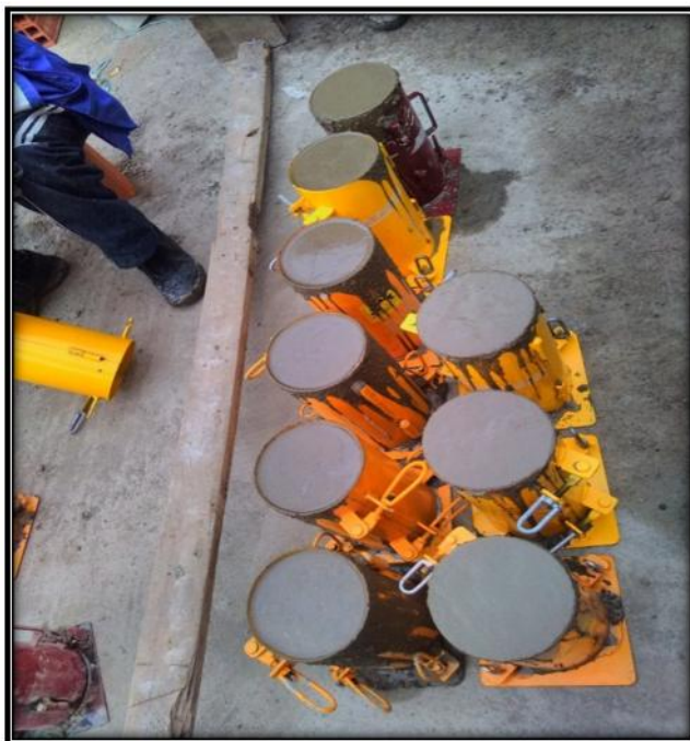
Fig. 109. Toma de testigos de concreto para laboratorio
