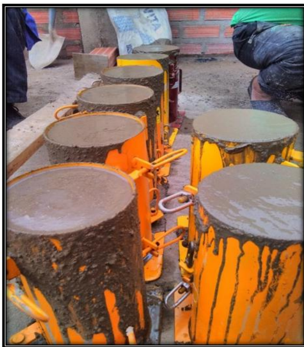
Fig. 109. Toma de testigos de concreto para laboratorio
