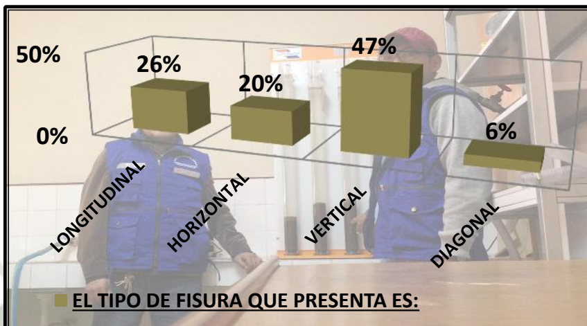
Cuadro N° 49. Histograma del tipo de fisura que presenta la vivienda.
