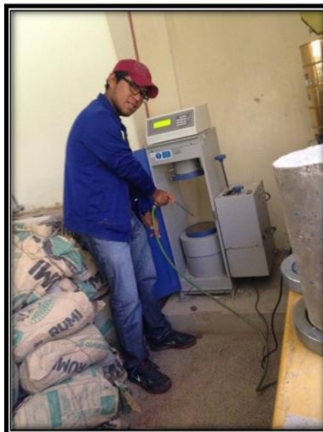
Figura 17. Evaluación de rotura de testigos de concreto.
