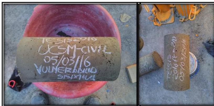
Fig. 120. Testigos de concreto para ensayo en laboratorio
