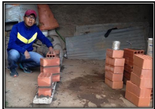
Figura 19. Preparación de pilas de ladrillos.
