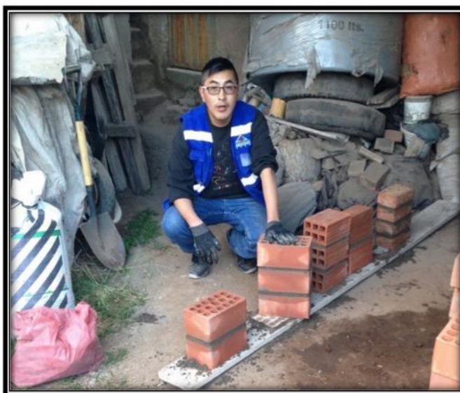
Figura 20. Pilas de ladrillos de distintos aparejos.
