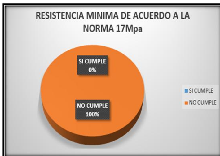
Fig. 121. Resistencia mínima alcanzada en las viviendas
