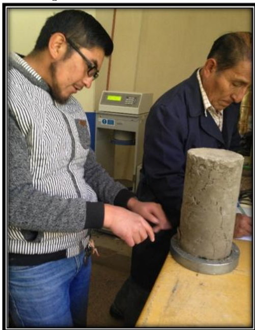
Figura 16. Rotura de testigos de concreto.
