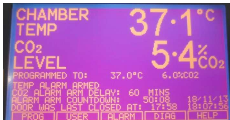
Pantalla de la cámara de anaerobiosis donde indica la cantidad de co2 del medio y la temperatura
