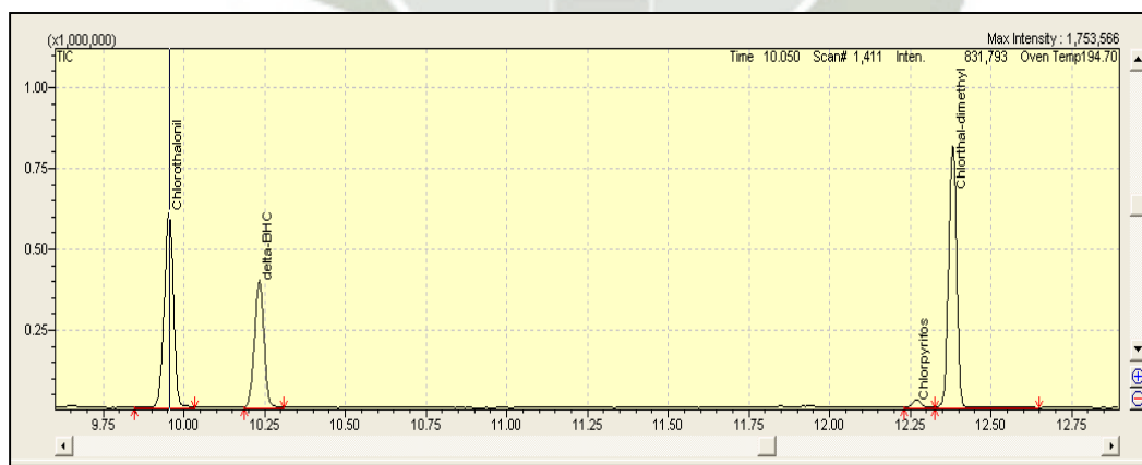
Figura N° I.3 Cromatograma obtenido en modo SCAN del estándar primario
