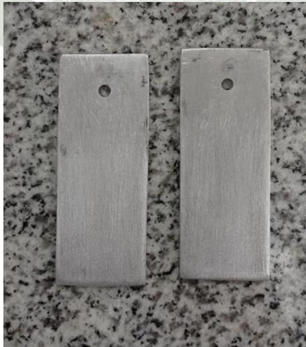
Figura 16: Electrodo de aluminio después del tratamiento inicial con ácido.
