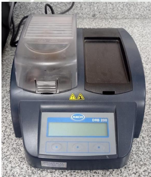
Figura 22: Efluente tratado diluido depositado en el digestor HACH DR200 y colorímetro DR900 (especificación técnica) para la lectura de DQO
