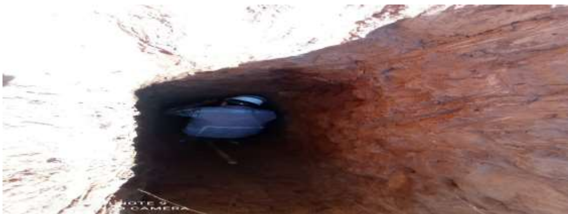
Figura 13. Extracción de muestras en la calicata
