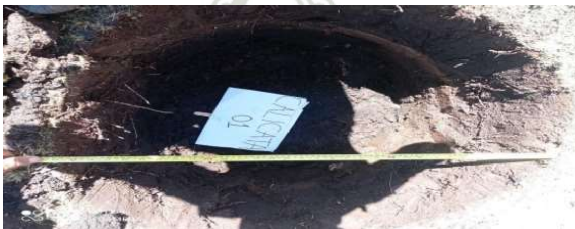
Figura 12. Extracción de muestra en la calicata
