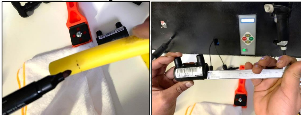
Figura 03: Marcado de tubería
