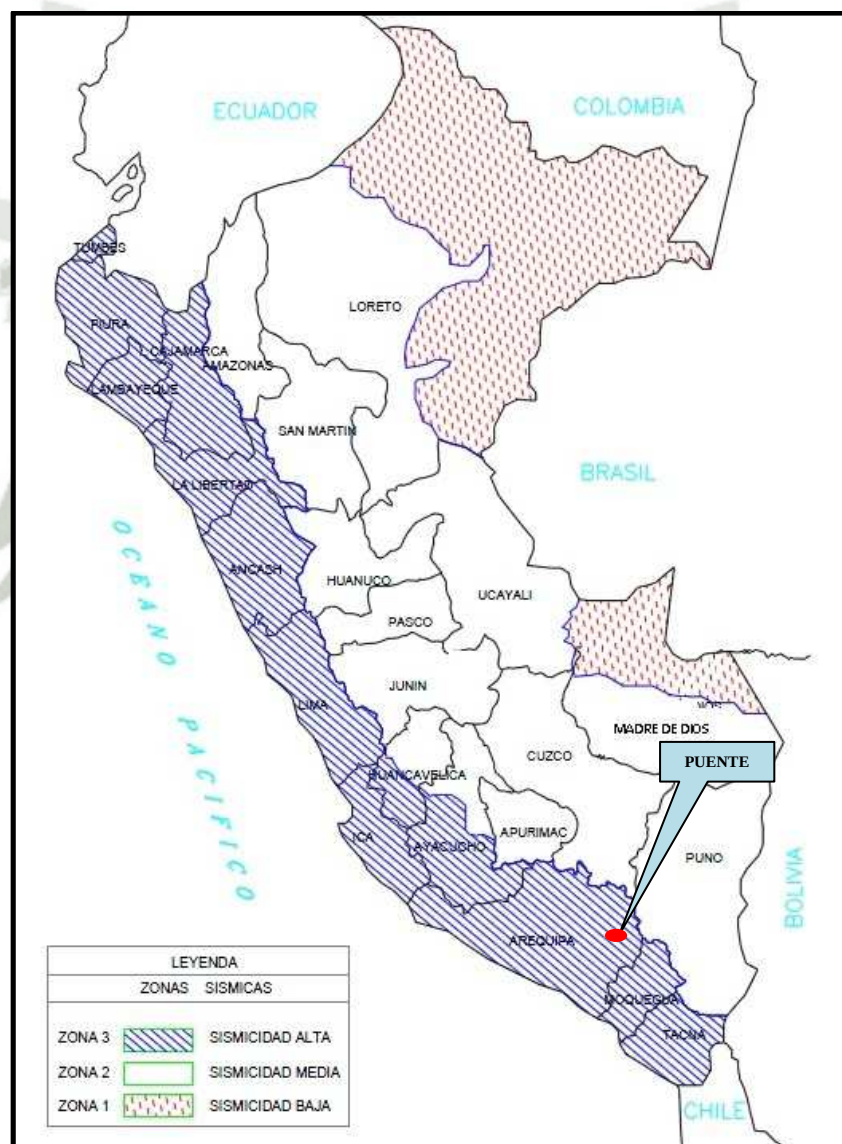
Figura 20 –Mapa de Zonificación Sísmica de Perú (Fuente: Norma Técnica Peruana E-030. (2008). “Diseño Sismo Resistente”, Lima: El Peruano)
