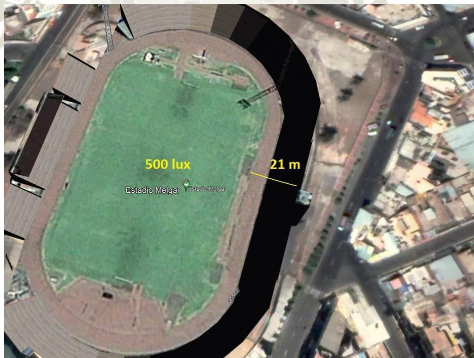
Figura 31 - Requerimiento de Lux, considerando que el estadio tiene la capacidad para hasta 15000 espectadores
