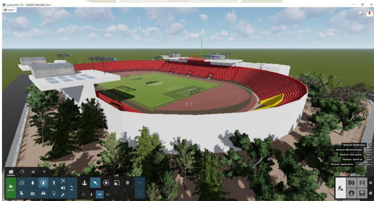
Figura 55 - Alternativa ideada II, con 4 bases de concreto con estructuras metálicas para ubicación de las lámparas reflectoras, sin torres, y de igual manera con vegetación arbórea a su alrededor.
