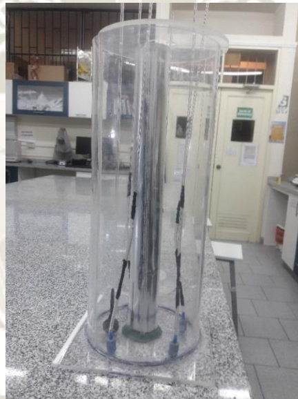
Figura 7. Ensamblaje del fotobiorreactor Fuente: Elaboración propia
