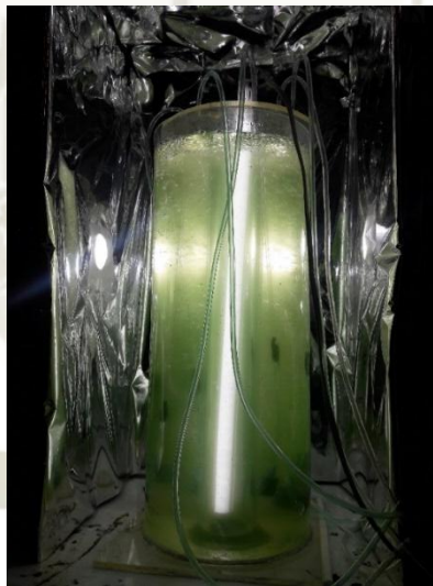
Figura 10. Fotobiorreactor a condiciones controladas de cultivo Fuente: Elaboración propia
