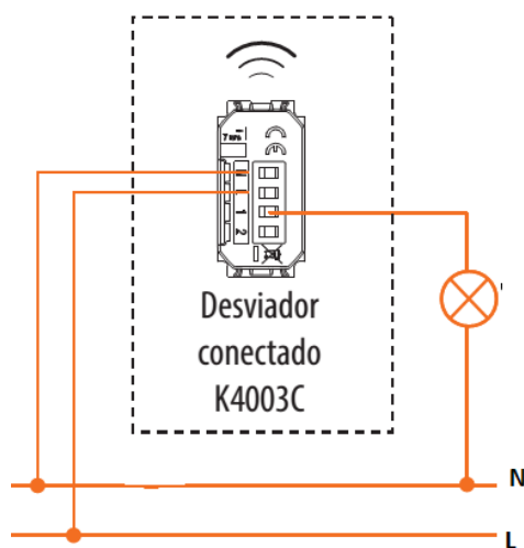
Figura 40: Esquema de conexión del interruptor simple Smart
