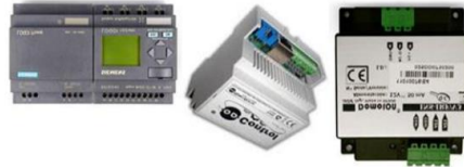
Figura 11: Módulos controladores. Logo de Siemens (iz.), OD Control de Open Domo (centro) y Domolon de ISDE.
