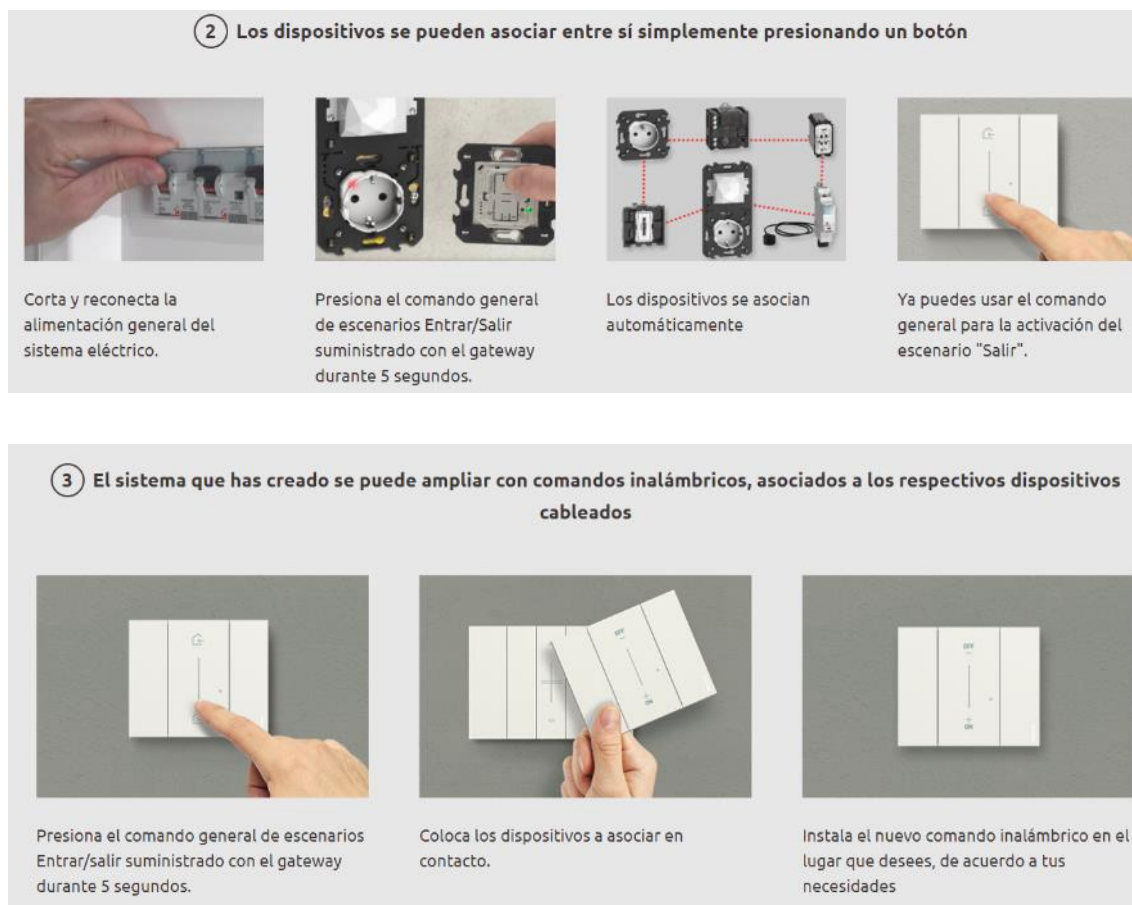
Figura 42: Procedimiento de instalación dispositivo Smart, incluye L+N Fuente Bticino, (2022)
