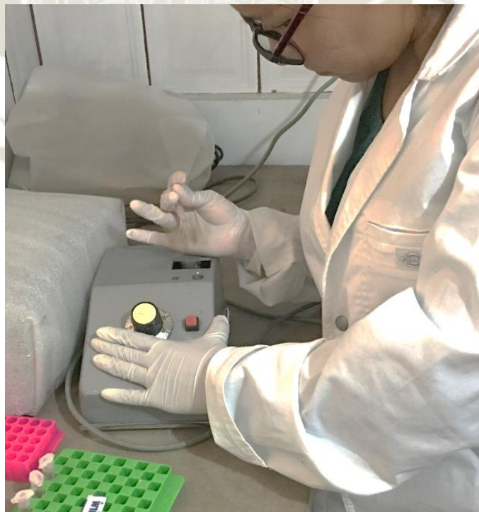
Imagen 7: Vortex, homogenizador de muestra.
