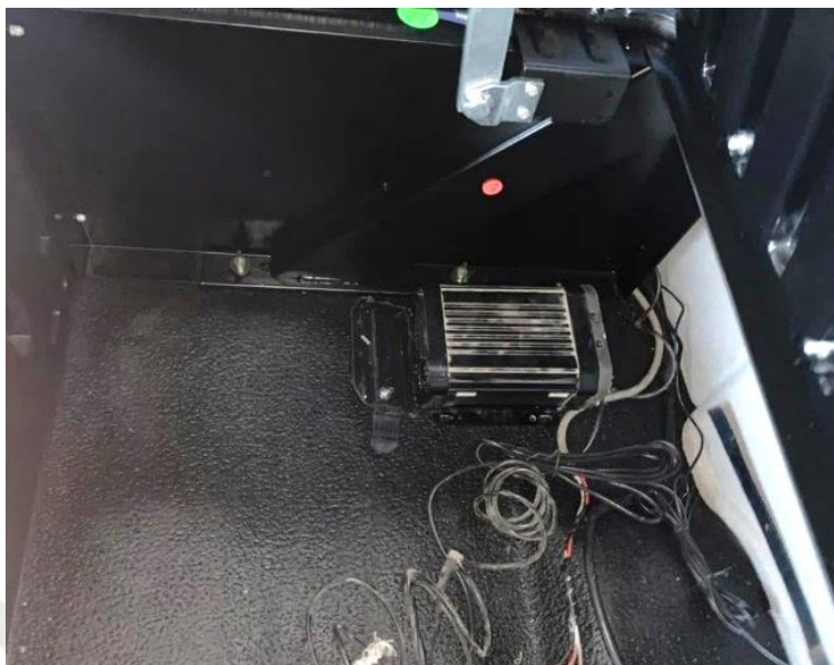
Figura 6 MDVR instalado bajo el camarote
