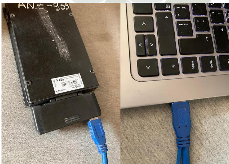
Figura 12 Conexión de HDD de MDVR a laptop a través de adaptador Intelbras
