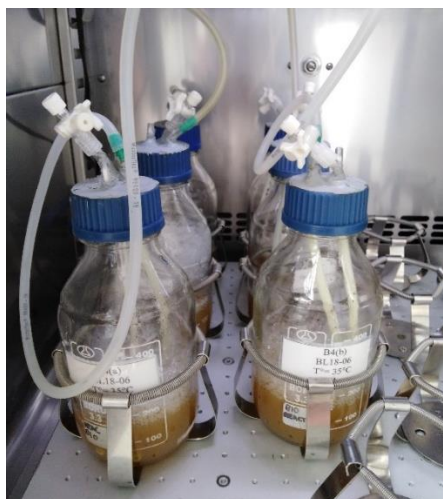
Figura N°5. Sistema de biorreacción para deslipidificar el sustrato agua de bombeo M7.
