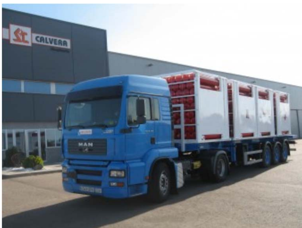
GRÁFICA 2.17. Botellas que contienen hidrógeno comprimido, transportadas en semirremolque
