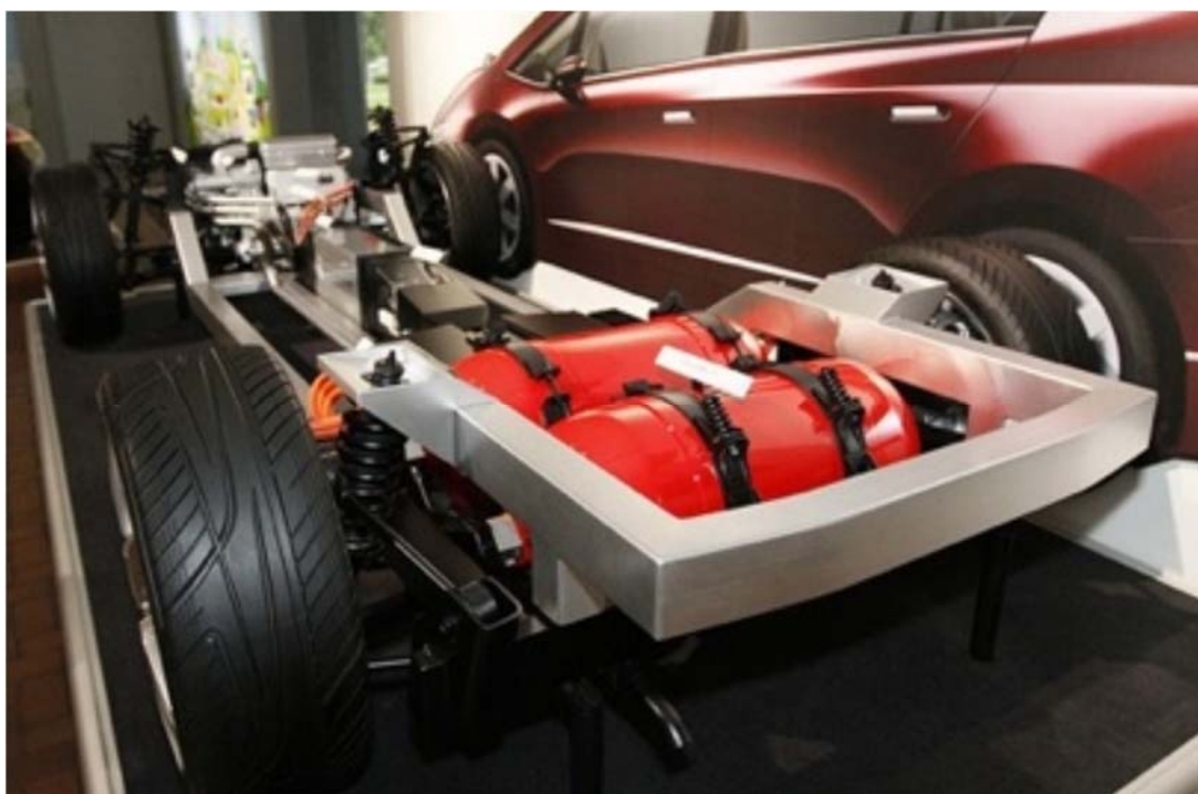
GRÁFICA 2.16. Tanque de almacenaje de hidrógeno líquido usado en automoción
