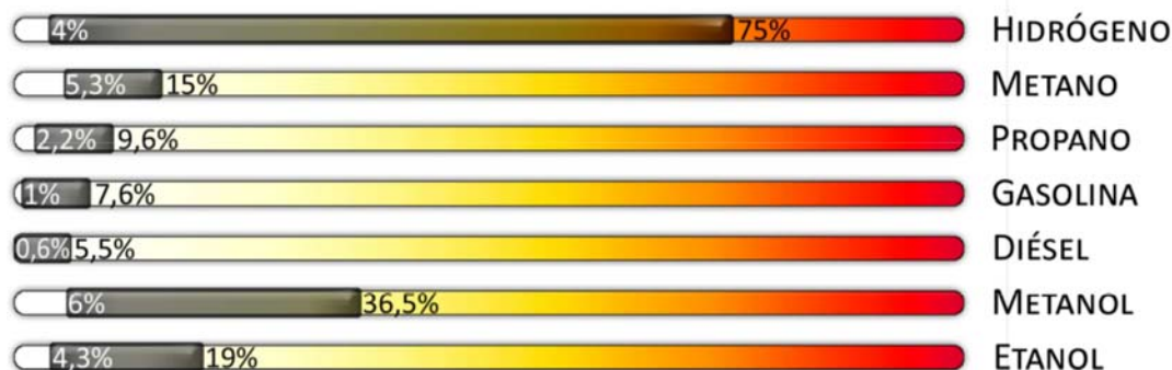
GRÁFICA 2.4. Rangos de inflamabilidad de diferentes combustibles a temperatura ambiente
