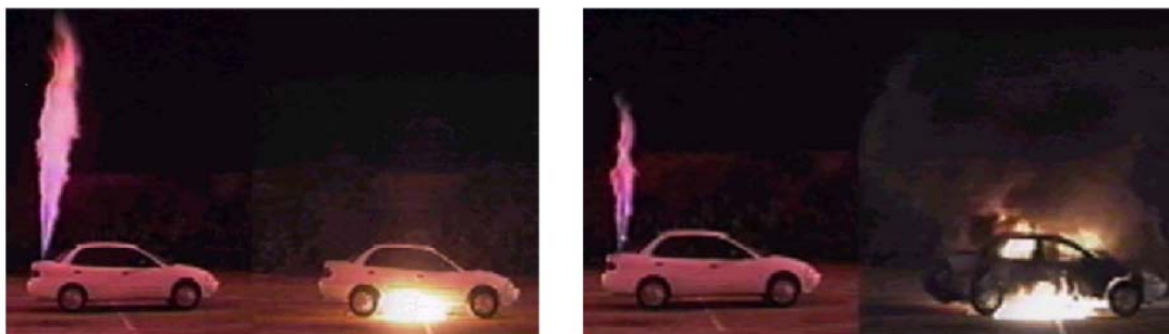
GRÁFICA 2.6. Secuencia de imágenes donde se observa la diferencia de comportamiento del fuego en caso de producirse un incendio en un coche alimentado por hidrógeno (coche de la izquierda) y en otro alimentado por gasolina (coche de la derecha).
