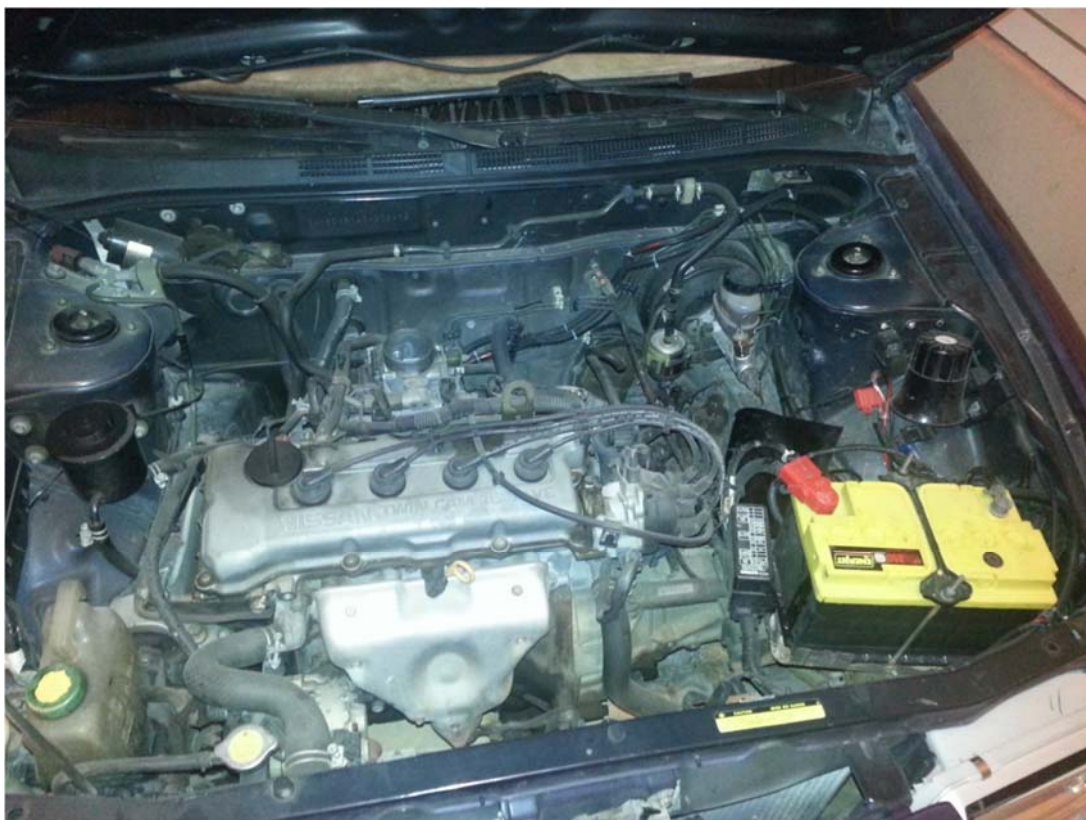
GRÁFICA 3.3. Motor Ga16DNE, vehículo de prueba
