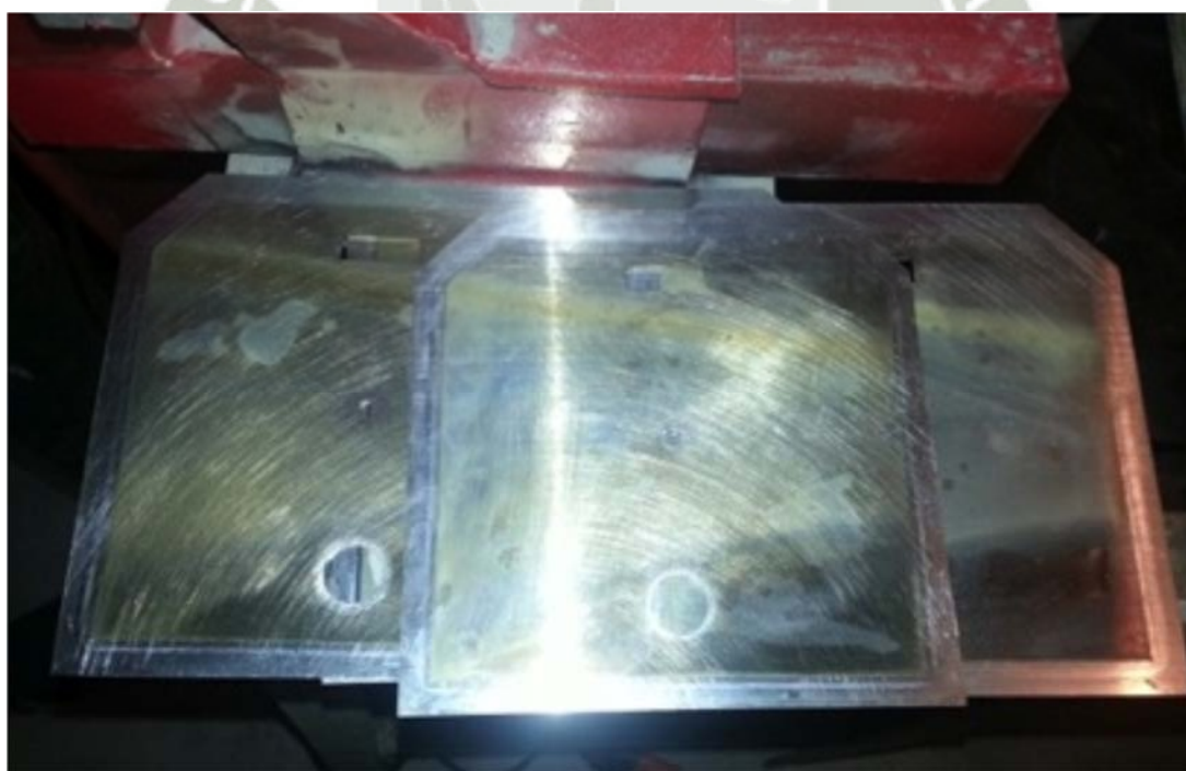
GRÁFICA 4.2. Placas metálicas con signos de corrosión y sarro
