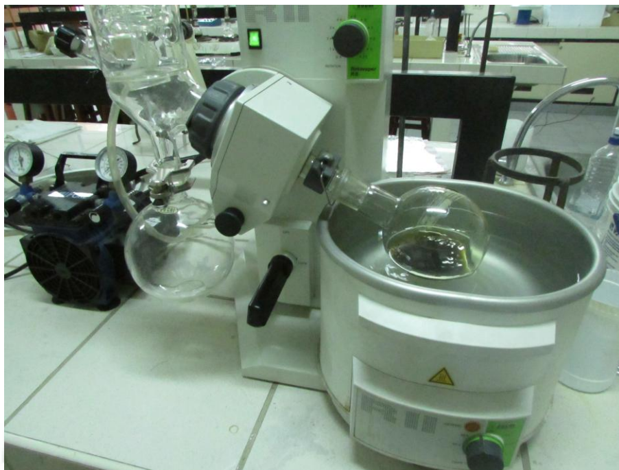
Figura 3.4 Evaporador rotatorio. Utilizado para evaporación del solvente.
