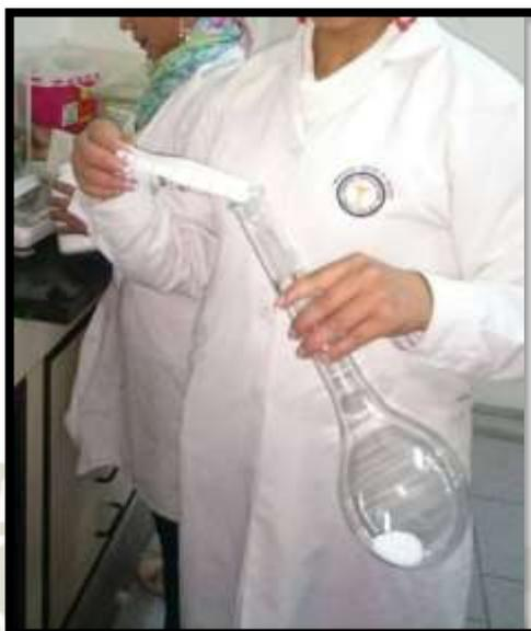
**Figura 2.1** Procedimiento para determinar proteínas por el método kjeldahl
