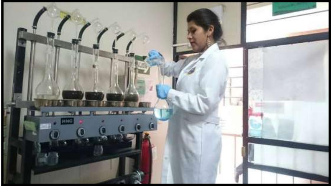
**Figura 2.3** Destilación del polvo de las hojas de Moringa de Método Kjeldahl
