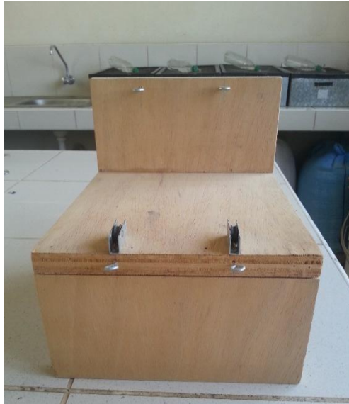
Figura N°16: Tensiómetro para realizar la resistencia mecánica de la cicatriz.
