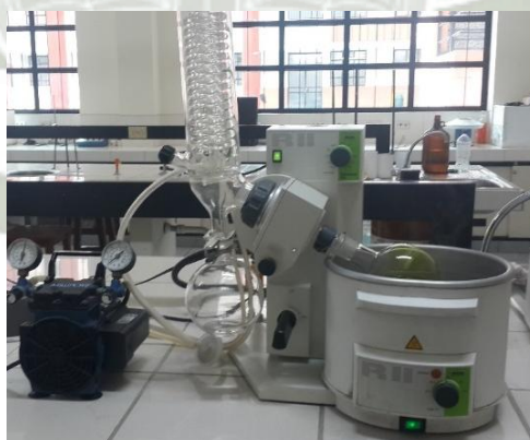
Figura N°12: Concentración al vacío de los extractos de Lippia nodiflora (tikil tikil) y la de Bidens pilosa (amor seco) mediante el equipo de Rotavapor
