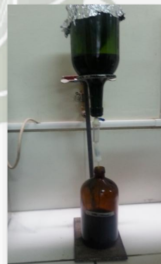
Figura N°11: Procedimiento de extracción de Lippia nodiflora (tikil tikil) mediante el equipo percolador
