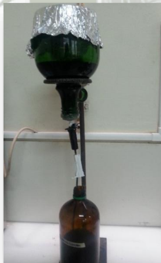
Figura N°10: Procedimiento de extracción de Bidens pilosa (amor seco) mediante el equipo percolador
