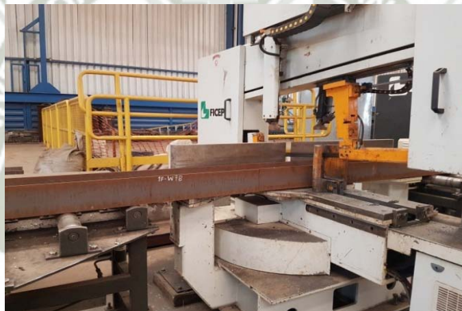
Foto N° 9: Habilitado Automatizado de Perfiles Estructurales
