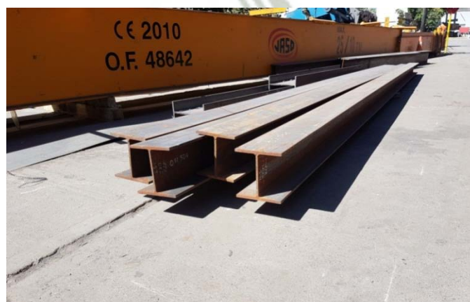
FotoN° 15: Viga de Acero Estructural
