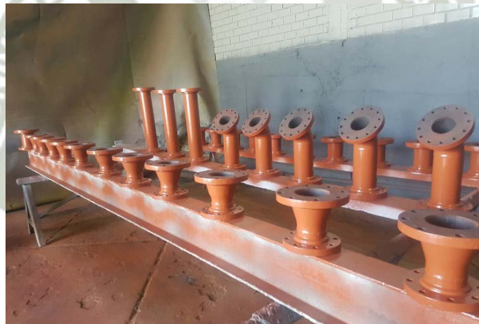
Foto N° 14: Pintado de Estructuras Metálicas
