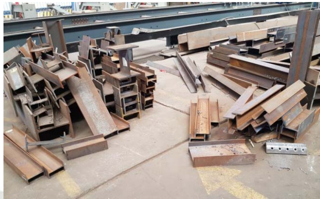
Foto N° 64: Almacenamiento de Material Sobrante (Perfiles)
