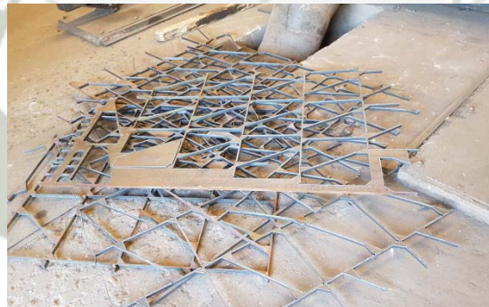
Foto N° 67: Esqueleto de Plancha Habilitada en CNC
