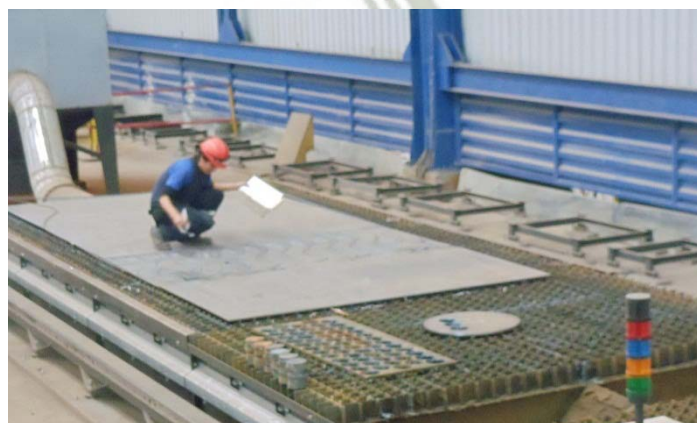
Foto N° 50: Codificación de Piezas Habilitadas
