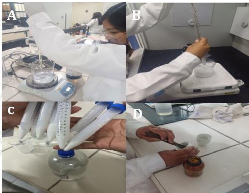
A) Adición de TTIP al agua ultrapura bajo agitación; (B) Incorporación de ácido acético para la estabilización del sol; (C) Lavado y sedimentación de las nanopartículas sintetizadas; (D) Secado y calcinación del material obtenido.
