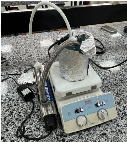
Figura 7 Implementación del reactor final para el tratamiento fotocatalítico
