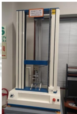
Figura 30. Máquina de tracción para polímeros.
