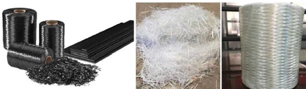
Figura 4. Fibras de carbón, vidrio y boro.
