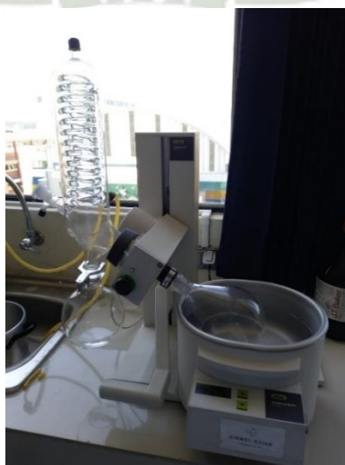
Figura 13. Separación de ácido láctico con el éter utilizando el rotavapor.
