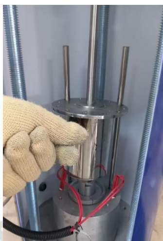
Figura 27. Fijación de la cámara de inyección.
