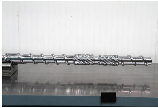
Figura 8. Tornillo de alimentación espiral para extrusión.
