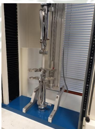
Figura 31. Prueba de tracción para el PLA.
