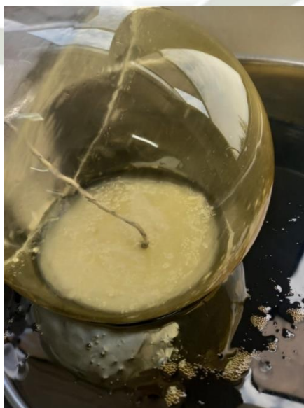
Figura 15. Polimerización del ácido láctico con catalizador.
