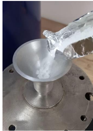
Figura 22. Abastecimiento de PLA a la cámara de inyección.
