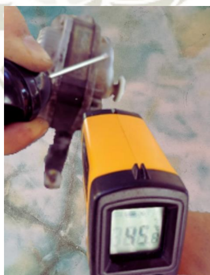
Figura 6.129 Tomando la temperatura de la parte trasera del motor
