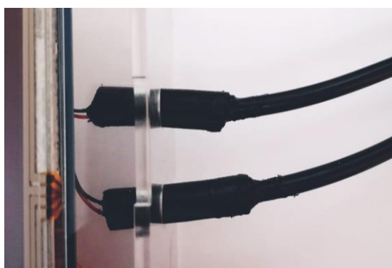
Figura 3.14 Micrófono Electret dentro de tubo PVC Fuente: Elaboración propia
