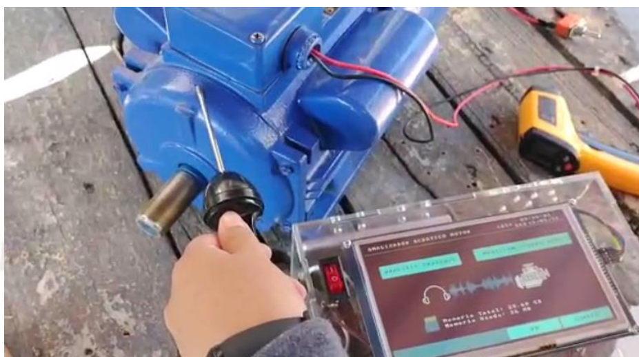
Figura 6.141 Colocando el estetoscopio en los rodamientos del motor Fuente: Elaboración propia
