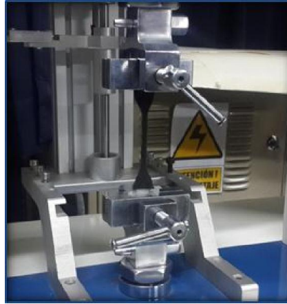
Figura N°2.24: Probeta instalada en mordazas para realizar el ensayo.
