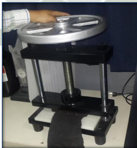
Figura N°2.22: Corte de material con troquel y prensa manual.
