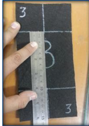
Figura N°2.33: Línea central y horizontal en probetas de ensayo.
