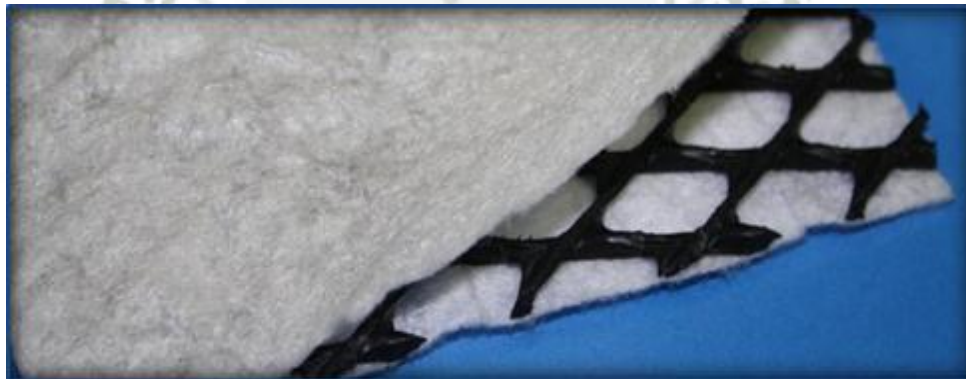
Figura 1.18: Geocompuesto drenante: Geotextil + Geomalla.
