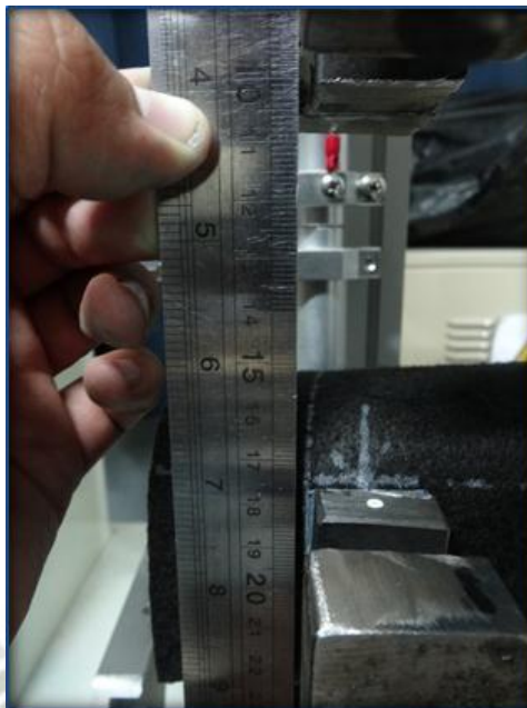
Figura N°2.34: Distancia entre mordazas al inicio del ensayo.
