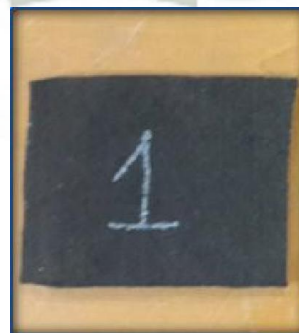
Figura N°2.25: Probetas de 100x100mm para ensayo de resistencia a la perforación. Fuente: Propia.
