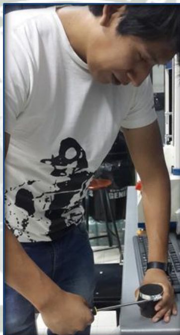
Figura N°2.26: Proceso de sujeción de probeta en placa de apoyo.
