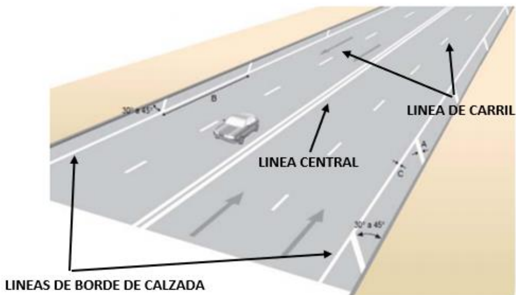
Ilustración 26: Ejemplo de demarcaciones planas en el pavimento
