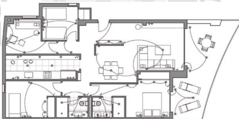
Figura 7 Distribución de salidas de iluminación
