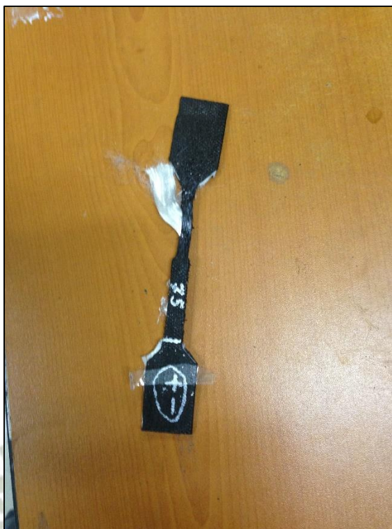
Figura A1.26 Probeta Normalizada de Cinta Polimérica de 75 KN ensayada a Tracción
