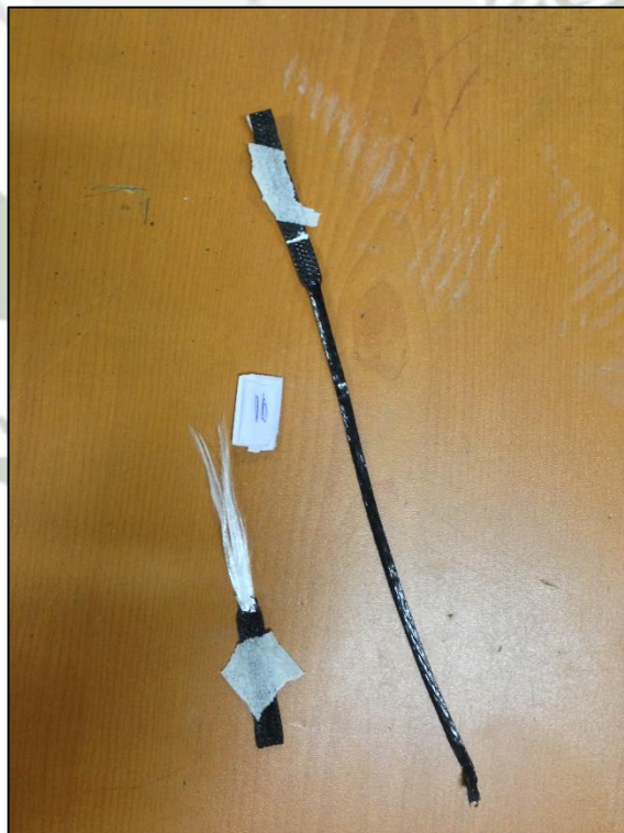
Figura A1.21 Cinta Polimérica de 30 KN ensayada a Tracción
