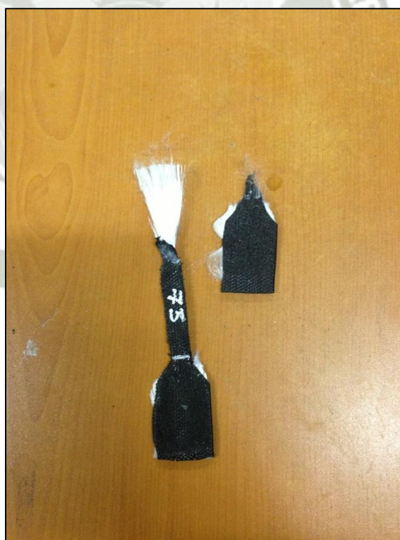
Figura A1.27 Probeta Normalizada de Cinta Polimérica de 75 KN ensayada a Tracción
