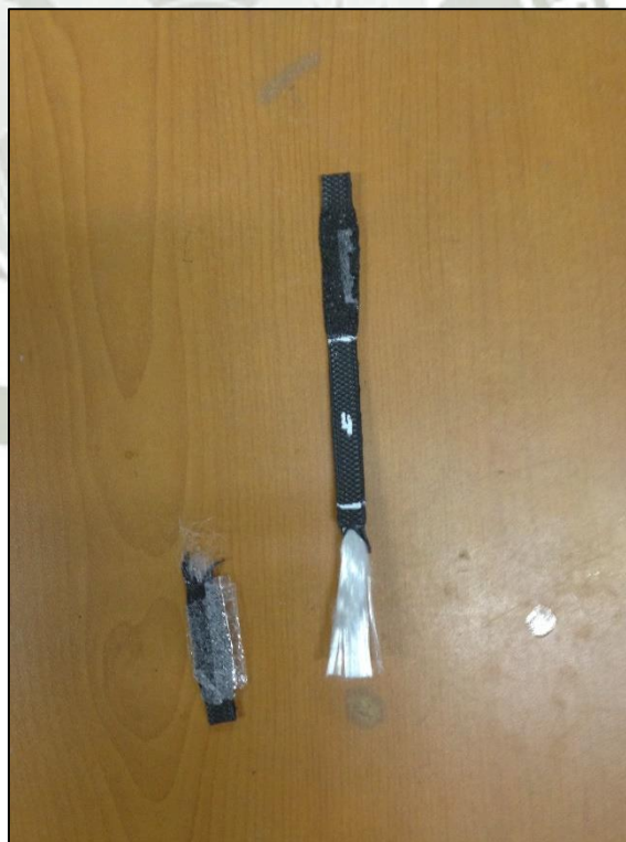
Figura A1.23 Cinta Polimérica de 50 KN ensayada a Tracción
