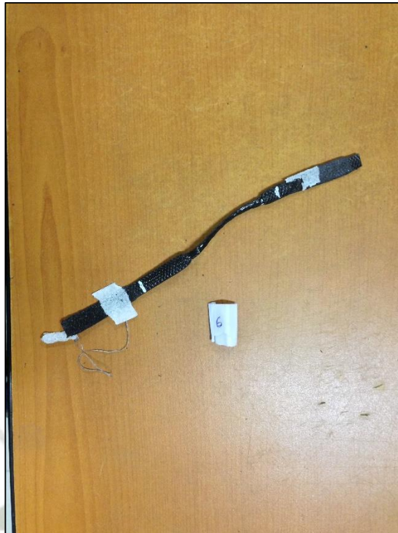
Figura A1.20 Cinta Polimérica de 30 KN ensayada a Tracción
