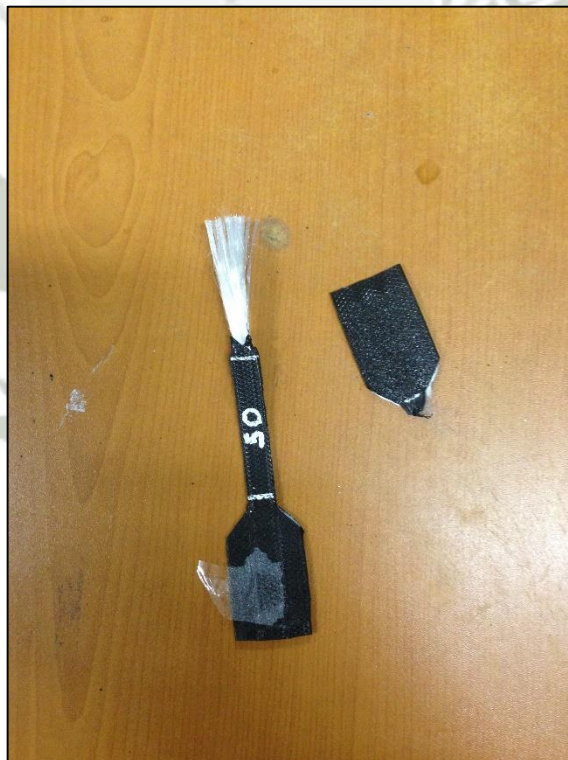
Figura A1.25 Probeta Normalizada de Cinta Polimérica de 50 KN ensayada a Tracción
