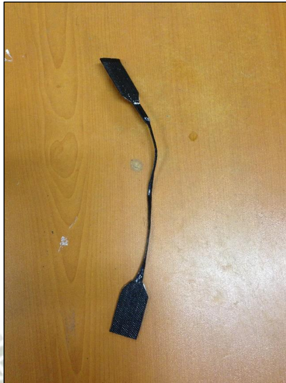
Figura A1.22 Probeta Normalizada de Cinta Polimérica de 30 KN ensayada a Tracción
