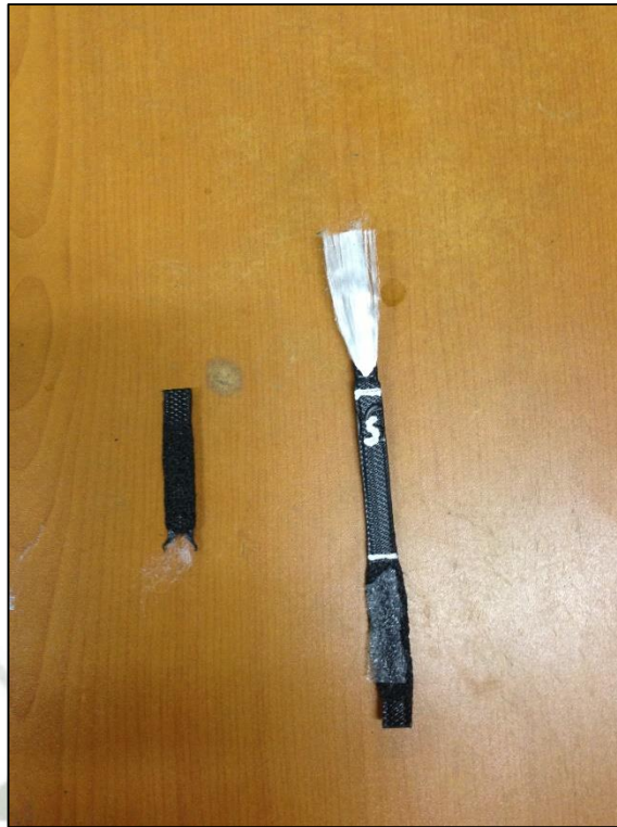
Figura A1.24 Cinta Polimérica de 50 KN ensayada a Tracción
