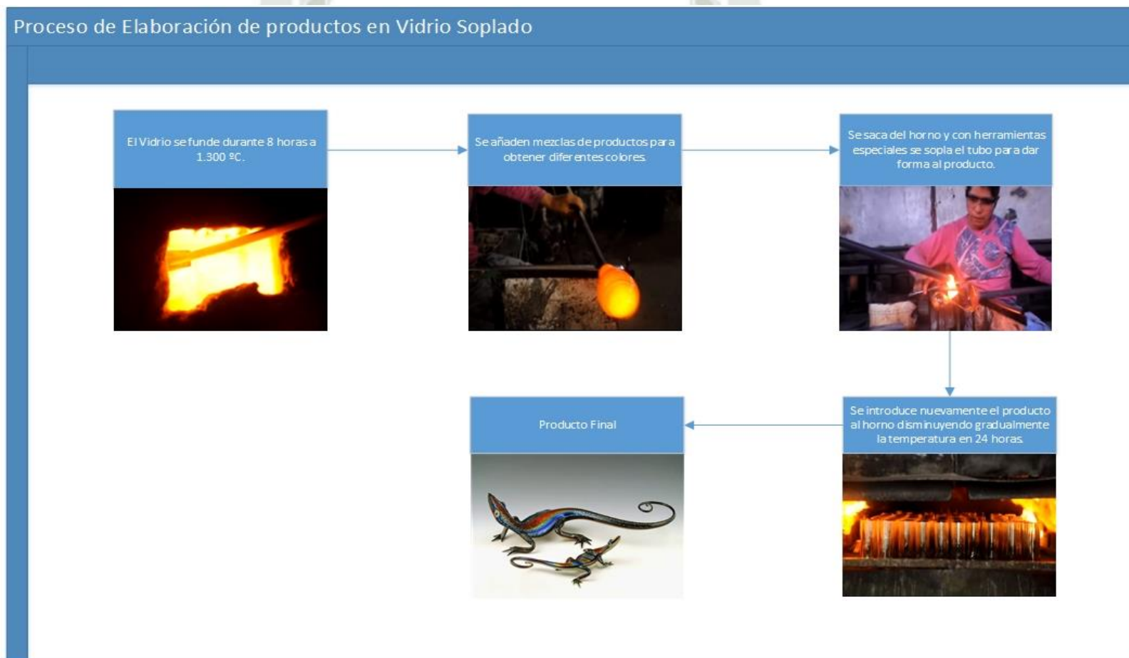
Gráfica N° 33: Proceso de Elaboración Productos de Vidrio Soplado
