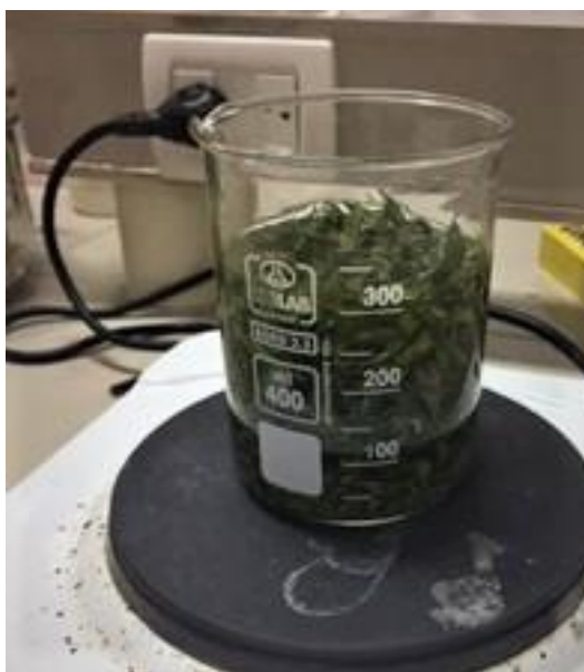
Fig. 11. Proceso de Extracción Hidroalcoholica de hojas de Tiquil Tiquil.
