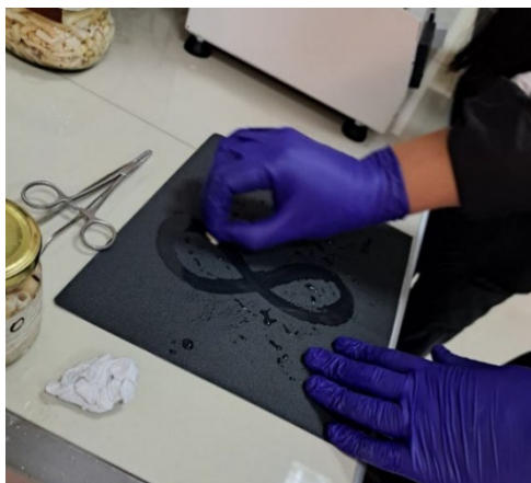
Figura 5: Pulido y estandarización del smear layer mediante el pulido de la superficie vestibular con lijas de agua.
