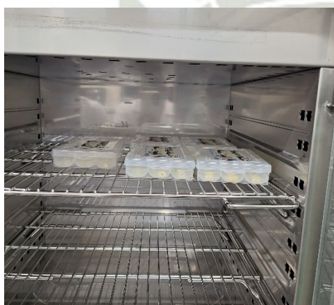
Figura 10 y 11: Colocación de especímenes en horno de laboratorio a 37°
