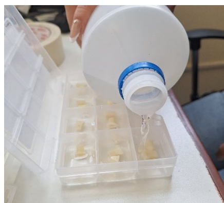
Figura 8 y 9: Almacenamiento de los especímenes en saliva artificial
