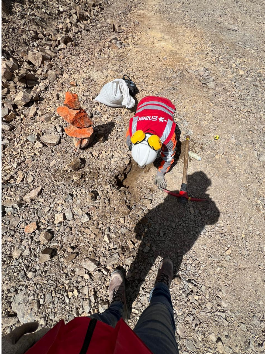
Figura 5 Posicionamiento de geófono
