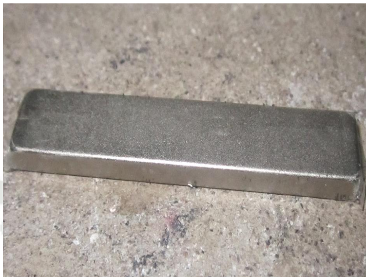
Fotografía 2. Imán de neodimio usado para el tratamiento magnético de agua de riego.
