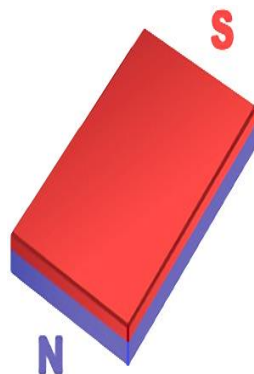
Figura 6. Distribución de los polos magnéticos en imán de Neodimio.
