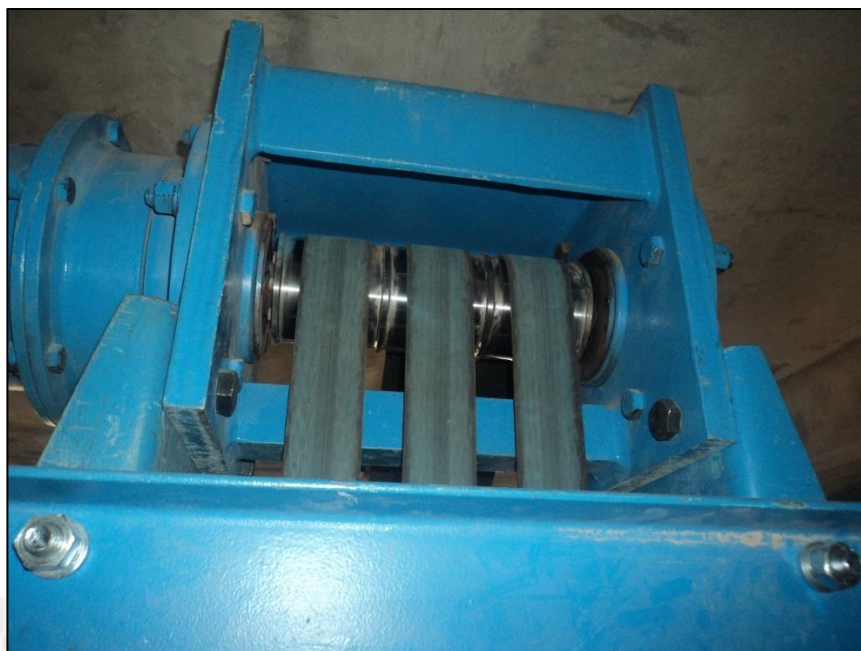
Ilustración 61. Polea de tracción para 03 fajas planas de tracción.
