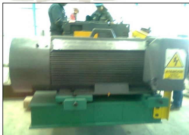
Ilustración 149. Motor de 4160 Vac de 250 HP.
