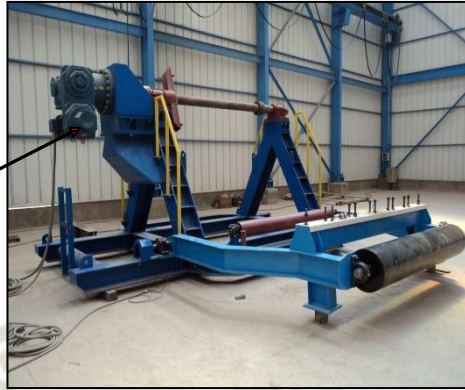
Ilustración 126. Variador de velocidad mecánico.
