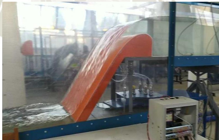
Figura 4-4. Vertedero de perfil Creager instalado y en funcionamiento.
