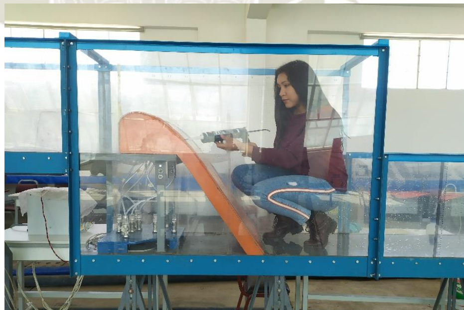
Figura 7-3. Instalación de vertedero de perfil Creager.
