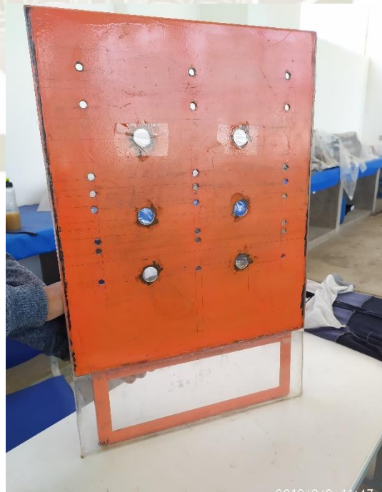
Figura 4-6. Vertedero de pared delgada con orificios cubiertos con cinta.
