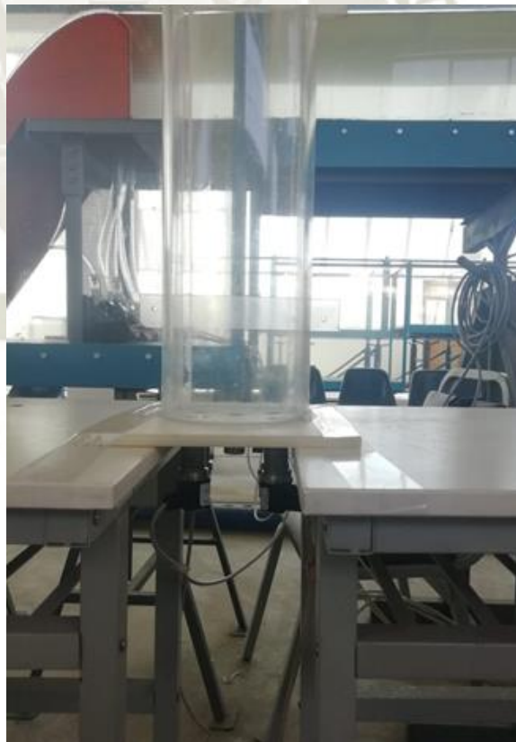
Figura 4-13. Tubo de acrílico graduado con transmisores de presión instalados en su base para calibrarse.
