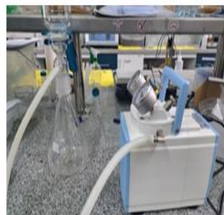
Sistema de Filtración al vacío por membrana.
