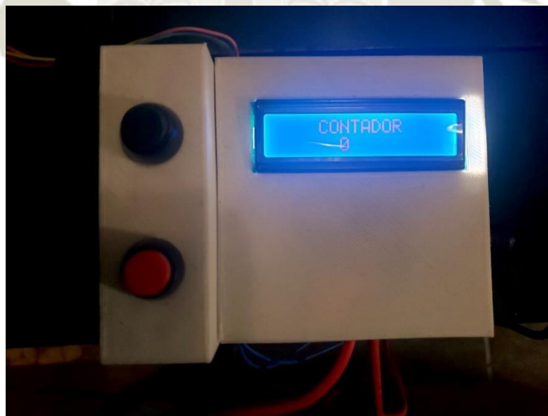
Figura 3-10 Caja que contiene circuito de control de módulo de fatiga por flexión rotativa Fuente: Elaboración Propia
