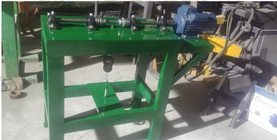
Figura 3-16 Módulo de Fatiga por Flexión Rotativa. Fuente: Elaboración propia
