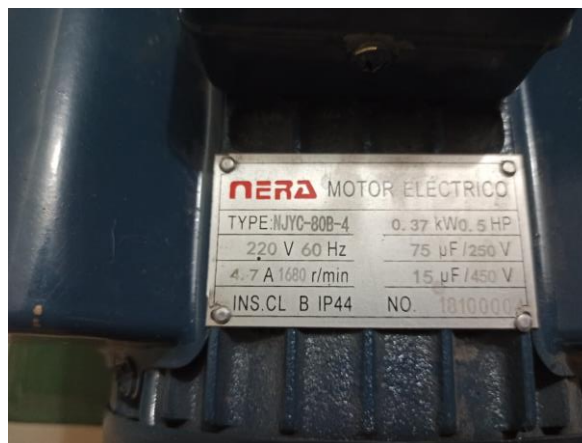
Figura 3-3 Placa de Motor de módulo de fatiga por flexión Rotativa. Fuente: Elaboración Propia
