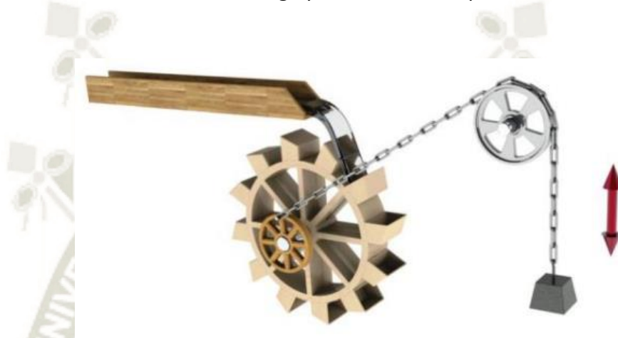
Figura 2-1 Mecanismo de Albert Wilhelm para comprender las fallas de cadenas de minería
