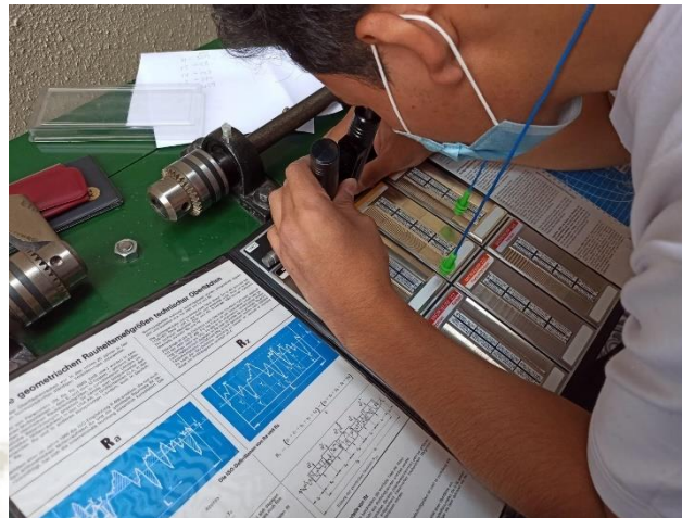
Figura 4-5 Medición de rugosidad por medio de comparación con patrones Fuente: Elaboración Propia
