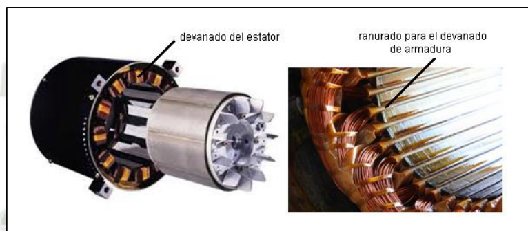
Figura 2.2 Devanado de estator y ranuras de armadura.
