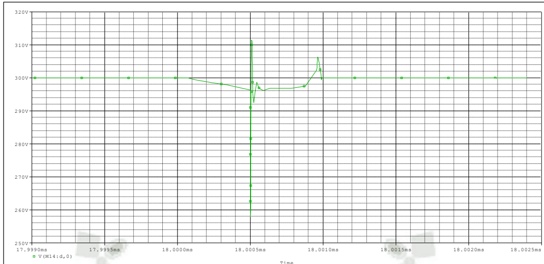
Figura 3.53 Variación de voltaje sin snubber.
