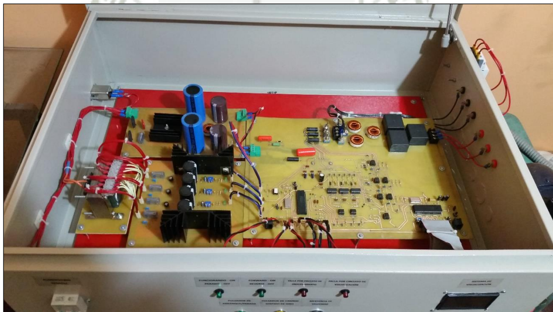
Figura D.4 Vista interior de VFD.
