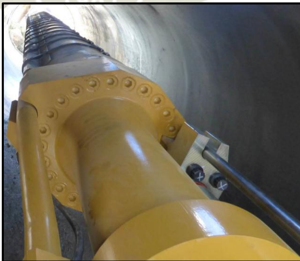
FIGURA 88. Abrazaderas instaladas en cilindro de Hydracrowd
