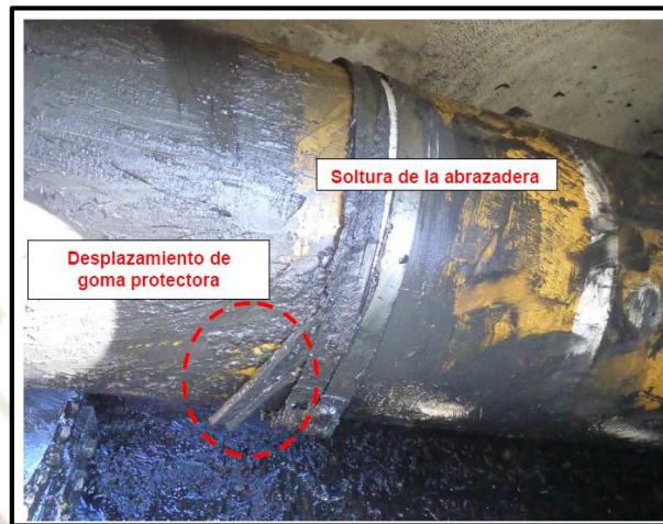
FIGURA 52. Inspección de goma y soltura de abrazadera de pala 2160
