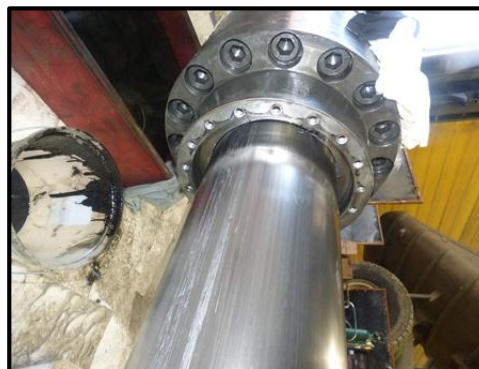
FIGURA 59. Rayaduras longitudinales del cromado pala 2162
