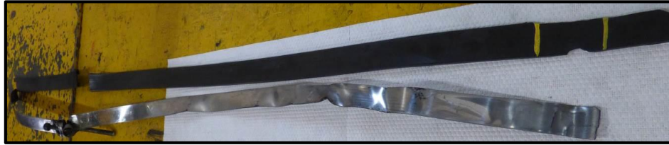
FIGURA 49. Abrazadera recuperada después de falla en pala 2160
