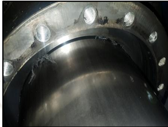
FIGURA 60. Sellos del cilindro desgastados pala 2162
