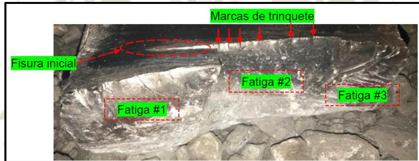
FIGURA 75. Fisura inicial, zonas de fatiga y marcas de trinquete #2 pala 2162
