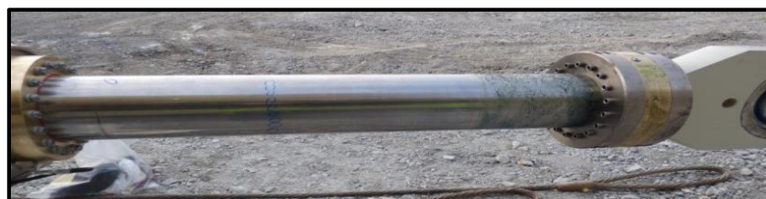
FIGURA 62. Vástago con defectos pala 2162
