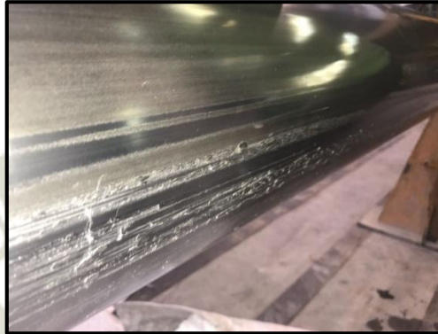
FIGURA 57. Desprendimiento de material cromado en vástago pala 2162
