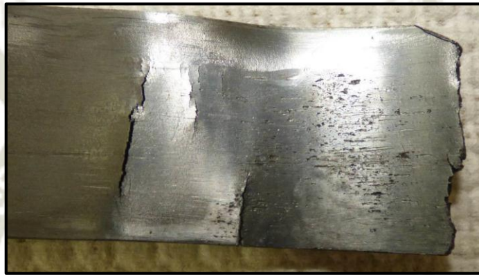
FIGURA 50. Desgaste abrasivo en cover en pala 2160
