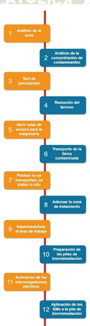
Figura 11. Diagrama que representa los pasos utilizados en el proceso de biorremediación en el derrame de diésel 2 en Camaná
