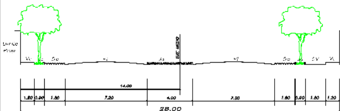
SECCION D-D (28.00) AVENIDA DE EVITAMIENTO
