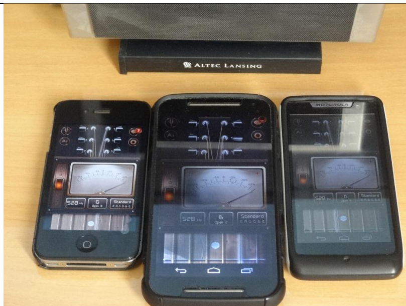
Medición externa por celulares Iphone, Motorola G5 segunda generación y Motorola G primera generación, con el programa Guitar Tuner, de parlantes ALTEC LANSING VS3121
