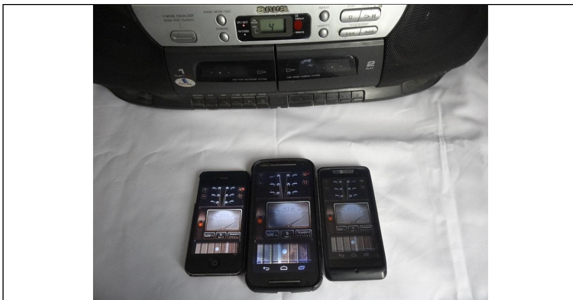
Medición externa por celulares Iphone, Motorola G5 segunda generación y Motorola G primera generación, con el programa Guitar Tuner, de equipo de sonido AIWA modelo CSD-SR5251
