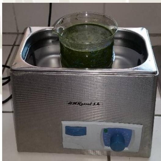
Figura 28 Obtención del extracto por ultrasonido
