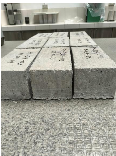
Preparación de adoquines para ensayo a la compresión
