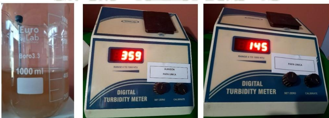
Resultados de la medición de la turbidez del agua sintética tratada con almidón de papa Única 50 ppm/ 30 min - 24 h
