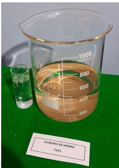
Agua sintética tratada con \text{FeCl}_3 50 ppm / 5 min y Polímero 40 ppm / 15 min.
