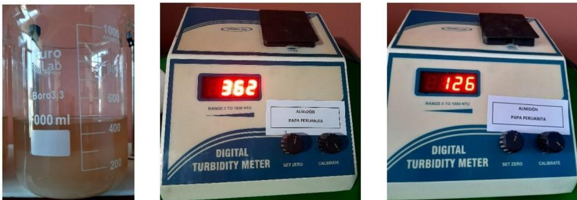
Resultados de la medición de la turbidez del agua sintética tratada con almidón de papa Peruanita 50 ppm/ 30 min - 24 h
