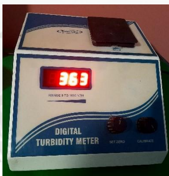
Medición de la turbidez del agua sintética sin tratamiento (363 NTU).
