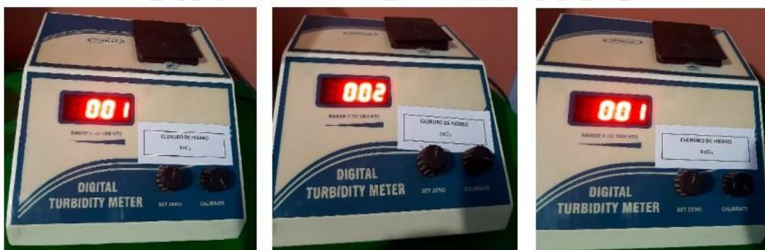
Resultados de la medición de la turbidez del agua sintética tratada con \text{FeCl}_3 50 ppm / 5 min y Polímero 40 ppm / 15 min.
