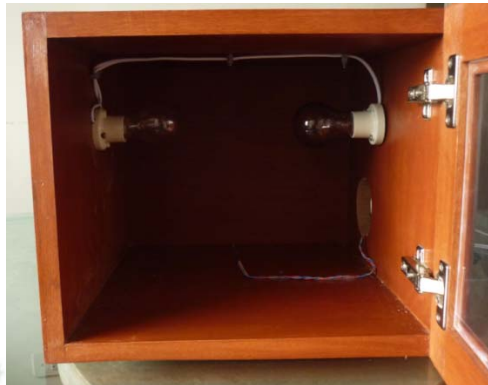
Fig.70. Interior de Cámara Térmica
