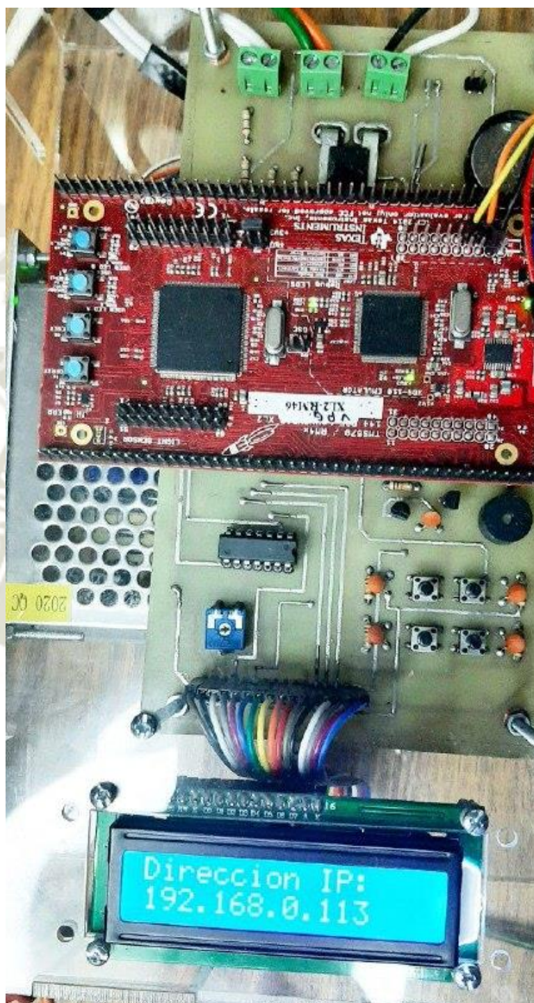
Figura 5.10 Equipo medidor de energía eléctrica
