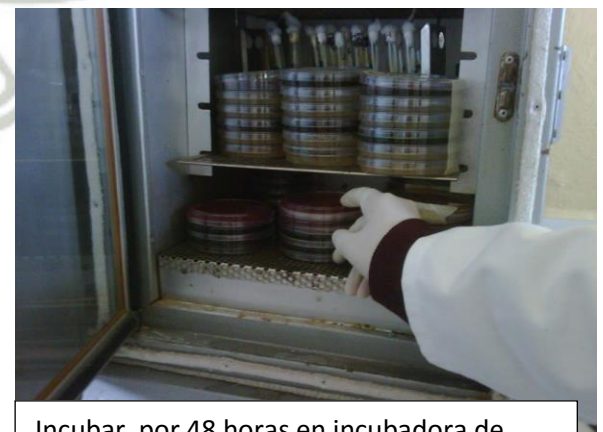
Incubar por 48 horas en incubadora de aerobiosis y cámara anaerobiosis en los casos requeridos.
