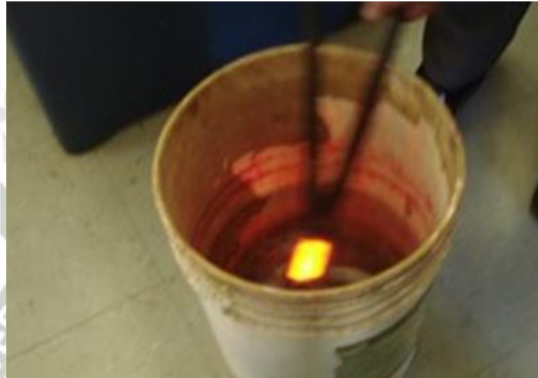
Figura 4.5. Enfriamiento de la probeta en forma de 8
