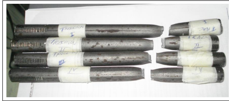
Figura 5.26. Probetas ensayo tracción: acero C 45E-EN 1008
