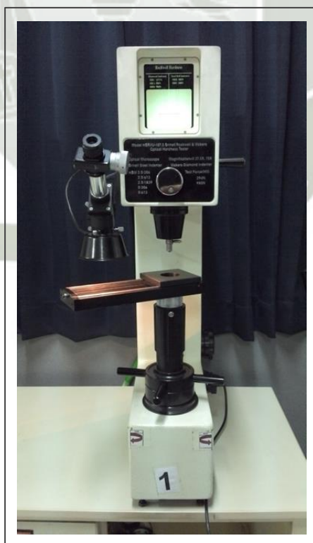
Figura 5.20. Durometro zwick/roell modelo: indentec
