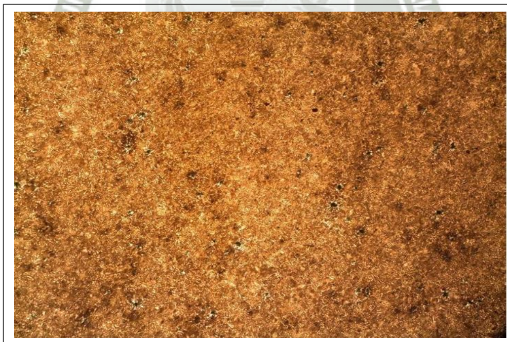
Figura 5.10. Probeta 2 enfriada a 500 °C. Acero ferrítico-perlítico de contenido medio de Carbono, tratado térmicamente. Se observan inclusiones tipo silicato. 100X
