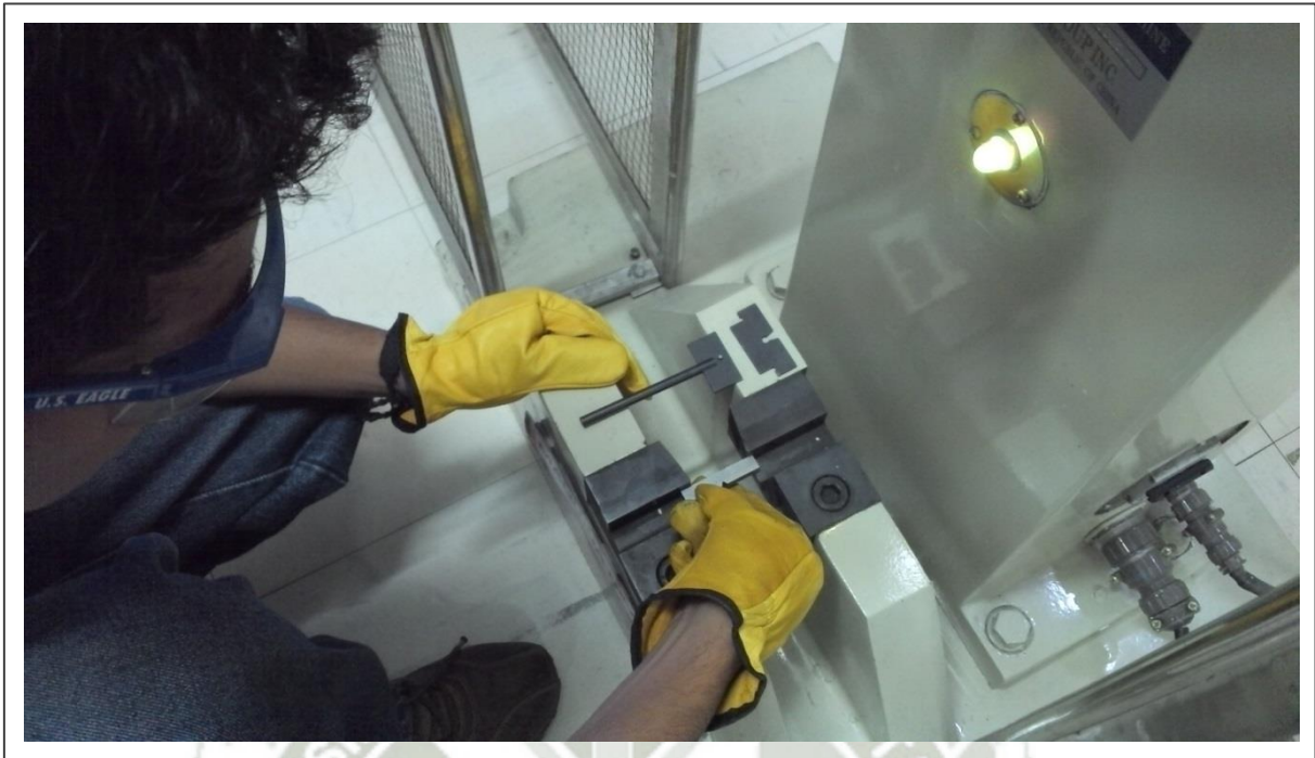
Figura N° 5.3. Ubicación de la Probeta en el Yunque
