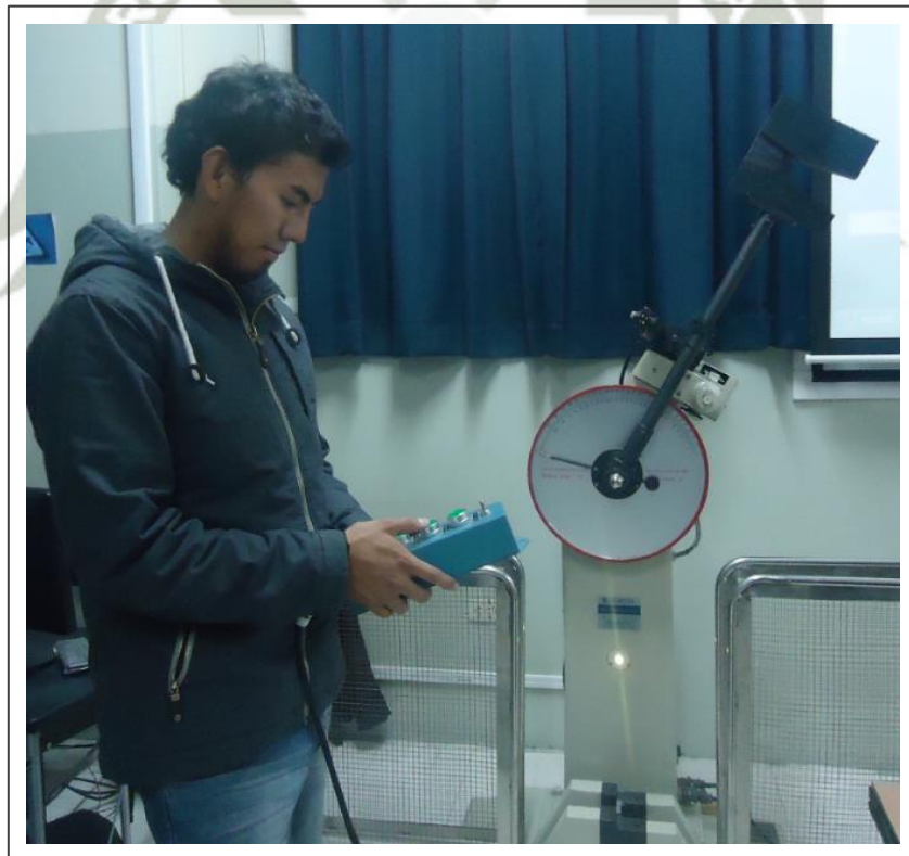
Figura N° 5.2. Péndulo en su posición inicial
