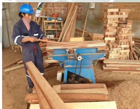
Foto 3.8. Operador sin Protección
