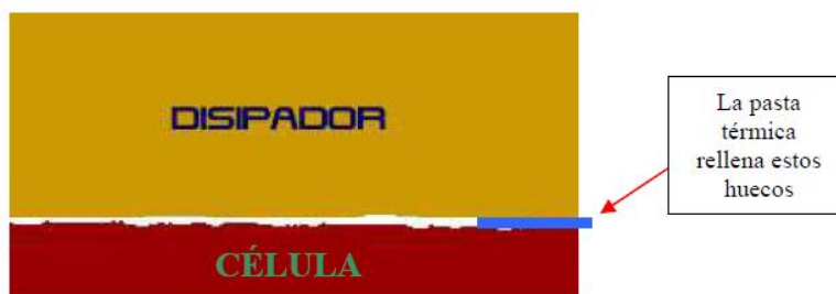
Huecos microscópicos entre célula y disipador
