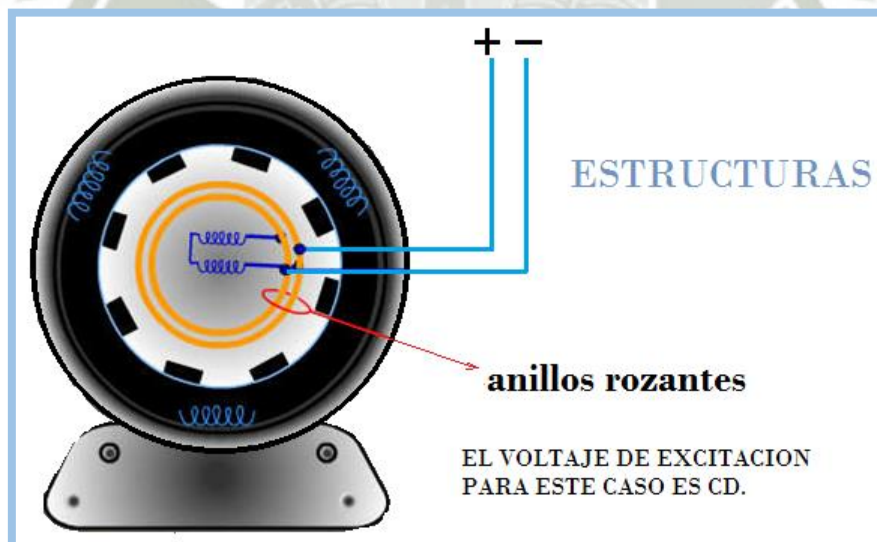
Figura N° 30: Máquina síncrona, con Inductor móvil e Inducido fijo. Fuente: Internet.
