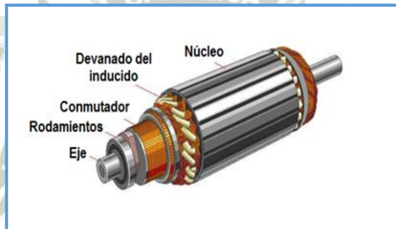
Figura N° 16: Partes del rotor de un motor DC.
