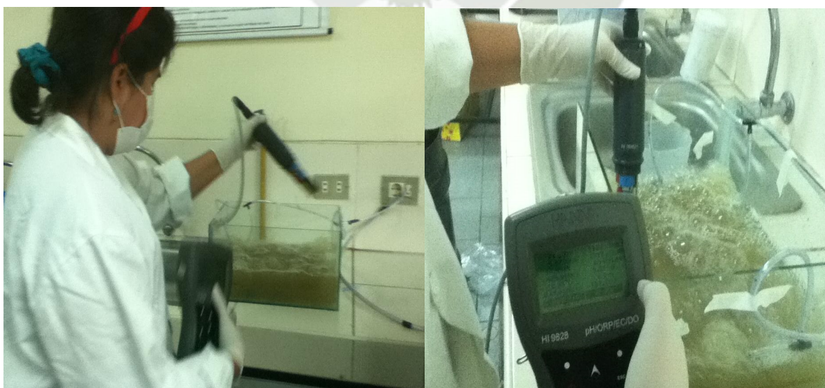
Figura 23 Cámara de Aireación sin lechos - Toma de datos fisicoquímicos equipo HANNA (P1-A)
