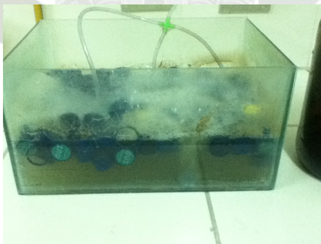
Figura 27 Cámara de Aireación con Lechos Tapas plásticas (P3-A)
