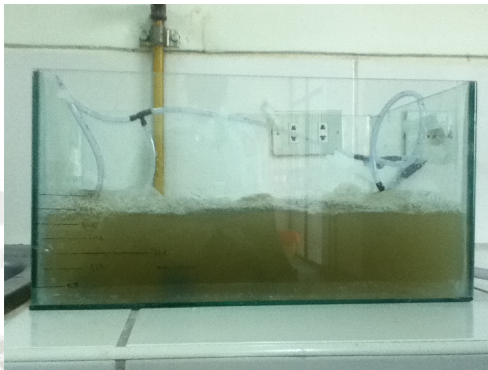
Figura 22: Prueba 1 - SAE con 12 litros de cribado, sin lechos móviles y con baja aireación Prueba P1-A
