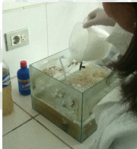
Figura 25: Cámara de Aireación con Lechos Especializados Kaldnes K1
